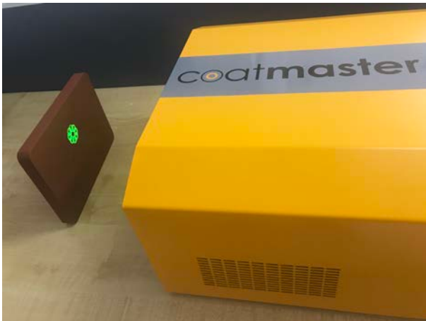
在线测量金属基板、家电或中纤板（MDF）等未干油漆或粉末涂层厚度得出干膜厚度，测试重复性及精度高
