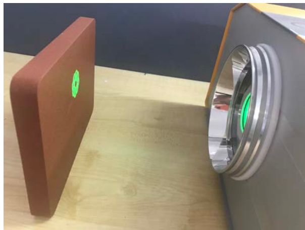
在线测量金属基板、家电或中纤板（MDF）等未干油漆或粉末涂层厚度得出干膜厚度，测试重复性及精度高
