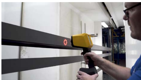
手持式非接触式膜厚分析仪轻松实时测量生产线上喷涂件膜厚，允许倾斜多角度测量
