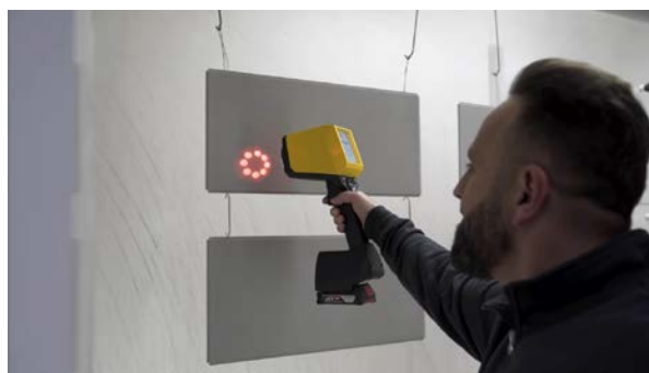
手持式非接触式膜厚分析仪轻松实时测量生产线上喷涂件膜厚，允许倾斜多角度测量
